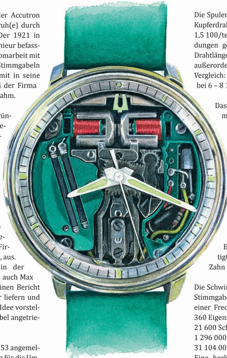
Die Spulen wurden mit einem gelackten Kupferdraht, mit einem Durchmesser von 1,5 100/tel (0,015 mm), mit 14000 Windungen gewickelt und sind mit einer Drahtlänge von mehr als 180 Metern eine außerordentliche Meisterleistung. Zum Vergleich: Ein Frauenhaar liegt in etwa bei 6 – 8 100/tel.
